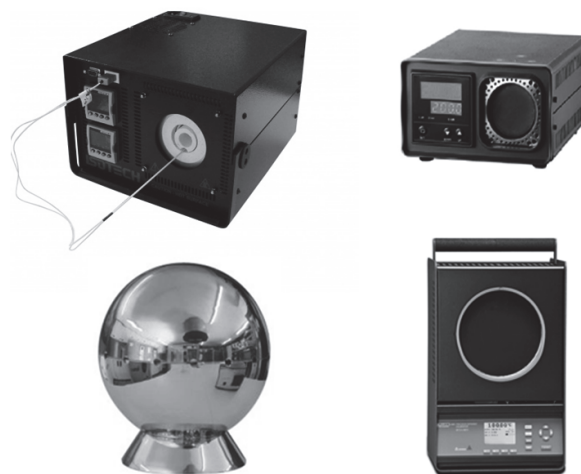
Obr. 22: Příklady komerčně dostupných černých těles pro kalibraci infračervených teploměrů: dutinová kalibrační tělesa (vlevo), desková kalibrační tělesa (vpravo)
