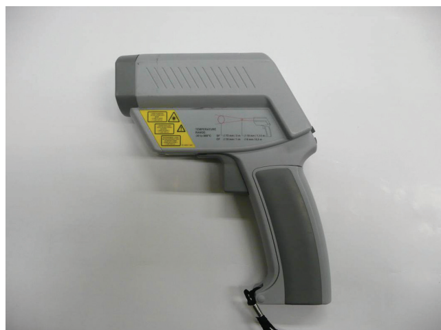
Obr. 3: Teploměr FLUKE 572 vybraný jako měřidlo kolující při porovnání
