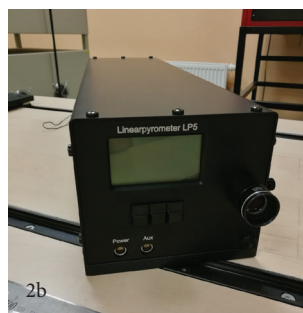
Obr. 2: 2a – pevný bod, 2b – lineární pyrometr LP5
