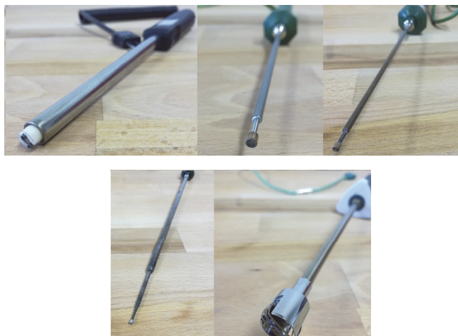
Obr. 2: Testované povrchové teploměry – nahoře zleva: Dostmann 112214 (A), Ahlborn TK122-2 4E (B), Ahlborn T122-2 11C (C), dole zleva: T150-1 7T (D), Ahlborn FTF109-PH (E)
